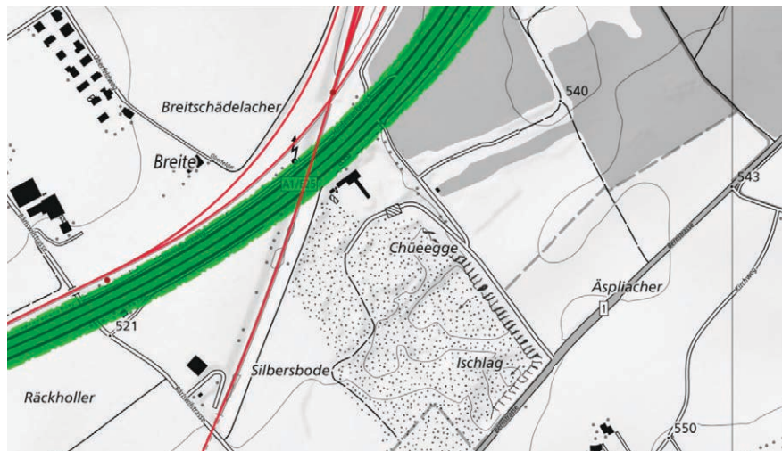
Abb. 12 Geltende Baulinie bzw. Abstandsvorschriften: in grün die Baulinien Nationalstrasse, in rot die Bahnlinien, bei denen bei Unterschreitung eines Abstandes von 50 m das Baugesuch zwingend der SBB zur Bewilligung abzugeben ist.
